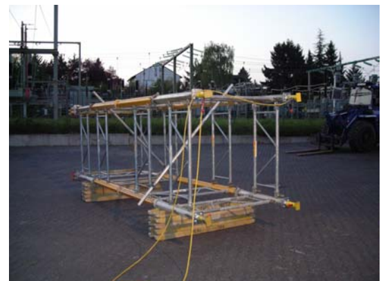
Bild 05 – Turmkonstruktion, liegend, Rastermaß 1500 mm, Länge 5400 mm – Gesamtgewicht = 473 Kg
