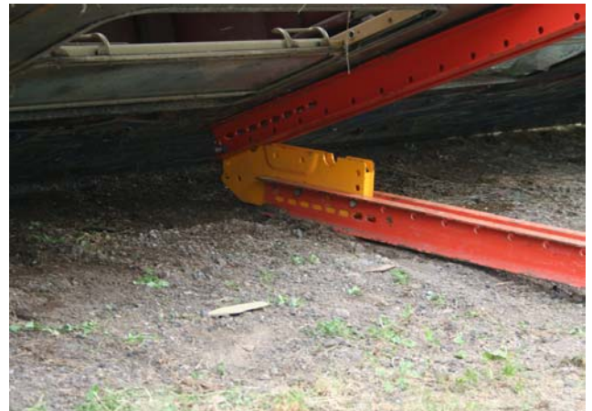
Bild 02 – Verbindung der waagerechten und der diagonalen SRU-Schiene mittels Verbinder UK 70
