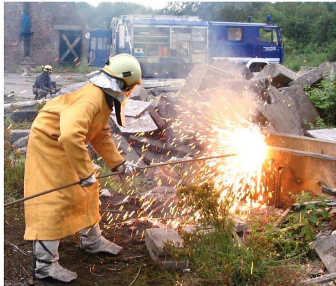
*Die Sauerstofflanze (hier auf dem KÜP in Eschborn) wird dieses Mal vorgeführt werden.*
