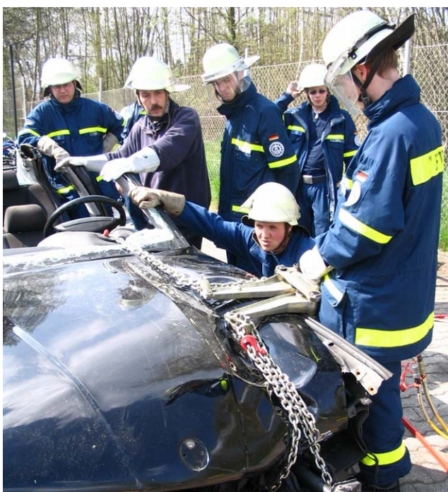
Miriam Hochheimer durchtrennt mit der hydraulischen Schere unter dem kritischen Blick von Ausbilder Gerhard Gembus (links) die C-Säule der Karosserie, um das Dach zu entfernen.
