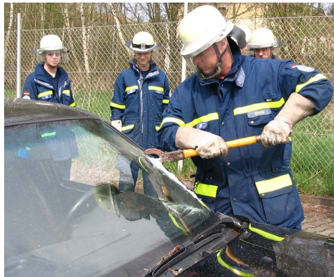
Gerhard Simon öffnet die Frontscheibe des Fahrzeugs mit einem Blechauftreißer.
