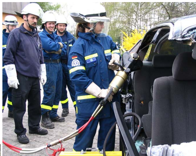
Miriam Hochheimer durchtrennt mit der hydraulischen Schere unter dem kritischen Blick von Ausbilder Gerhard Gembus (links) die C-Säule der Karosserie, um das Dach zu entfernen.
