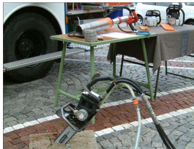
Betonkettensäge, im Hintergrund das Kernbohrgerät
